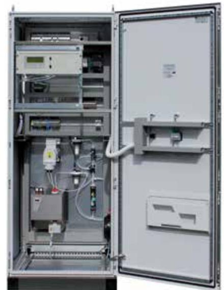
Analysesystem mit Gasaufbereitung, um konstante Messbedingungen zu erzeugen.
